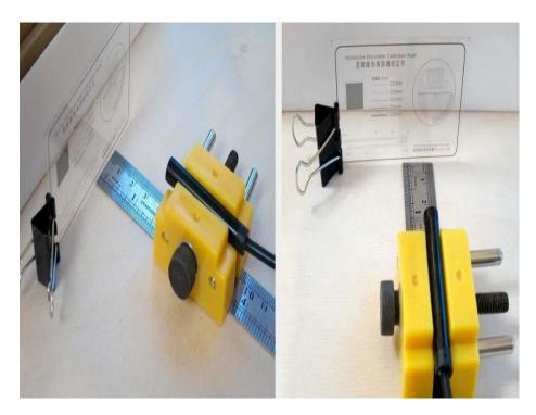
Проверяем. По описанию производителя, глубина резко изображаемого пространства или ГРИП эндоскопа лежит в пределах 30<sub>-</sub>80 мм. В действительности при 3 см изображение довольно расплывчато, что-то более-менее четкое начинается с 45 мм и продолжается до 75 мм.
