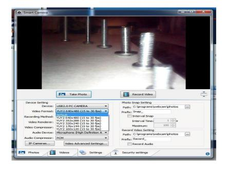
Максимальное разрешение 640 на 480 пикселей. Измерим один из технических параметров камеры - угол обзора. Соберем такой нехитрый стенд:
