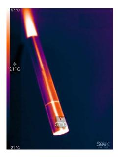
Что касается защиты от влаги и пыли, то заявлено IP67, но провод в месте выхода из металлического корпуса камеры никак не заделан и даже немного подвижен. Я не стал испытывать этот эндоскоп на герметичность по этой причине.
