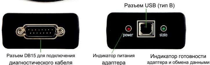
Рис. 1. Внешний вид адаптера «ECU-Link 3».
