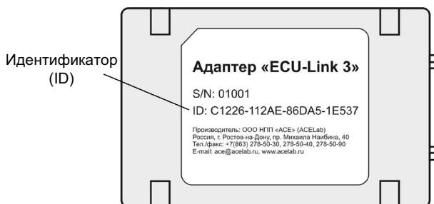
Рис. 2. Внешний вид адаптера с указанием идентификатора (ID)
