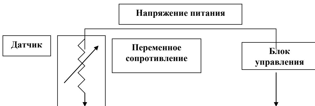
2. **Датчики переменного напряжения**, часто называемые «3-wire» (трехпроводные) датчиками, потому что они подсоединяются к компьютеру с помощью трех проводов: провод питающего напряжения (обычно 5 вольт), провод обратного сигнала и провод заземления. Датчики переменного напряжения включают датчики положения дроссельной заслонки, датчики абсолютного давления в коллекторе, датчики барометрического давления и некоторые датчики массового расхода воздуха.
