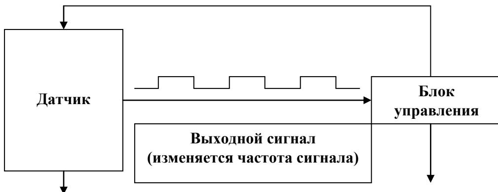
Датчик детонации также генерирует частотный сигнал. Он генерирует сигнал, если регистрирует вибрацию блока или головки двигателя, сопровождающую детонации. Когда компьютер принимает сигнал от датчика детонации, он на некоторое время изменяет момент зажигания (в сторону уменьшения опережения), до прекращения детонации.
