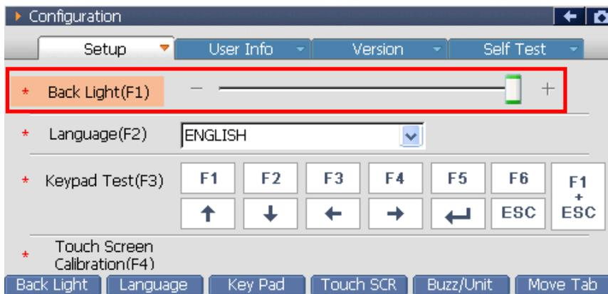
[Рис. 4] Регулировка подсветки ЖК дисплея
