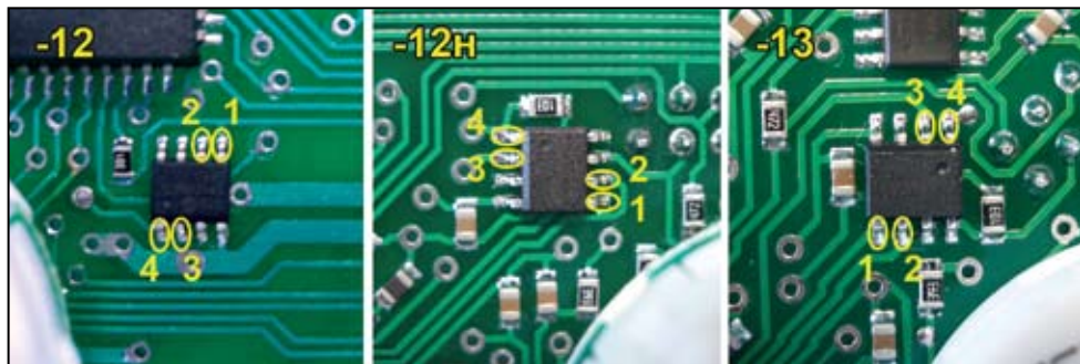
Рисунок А18. Точки пайки щупов насадки №1 для программирования
