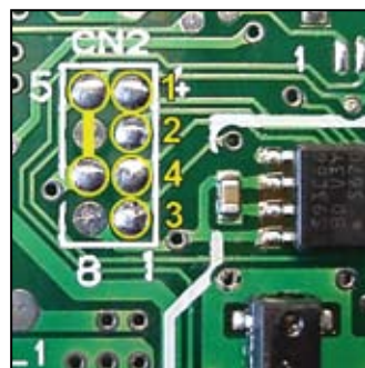
Рисунок А23. Точки программирования и установки перемычки
