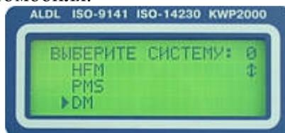
**Считывание и обнуление кодов неисправностей.** Коды неисправностей выводятся с расшифровкой на русском языке. Считанные коды ошибок можно сохранять в энергонезависимой памяти прибора для последующего анализа.
