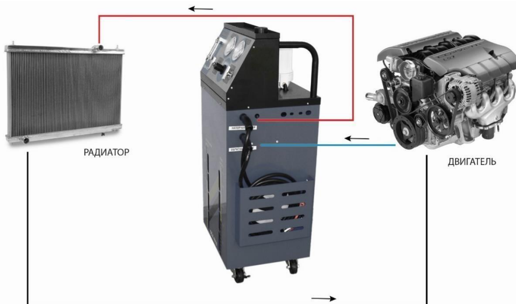
Рис. 3 Схема подключения изделия к системе охлаждения автомобиля
