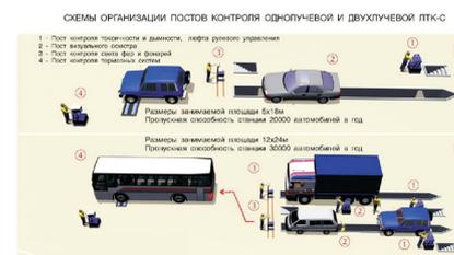
Две линии технического контроля грузовых и легковых автомобилей размещаются на одной комплексной платформе для всех типов автомобилей СТМ 3500М СТМ 1500М
