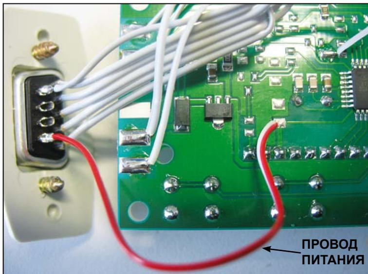
Рисунок 2. Точки пайки провода питания
