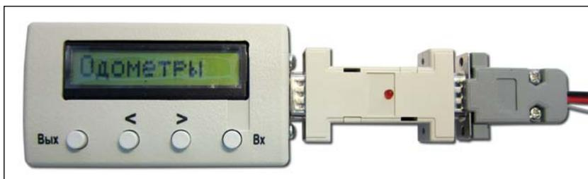
Рисунок 3. Подключение адаптера с насадкой к программатору
